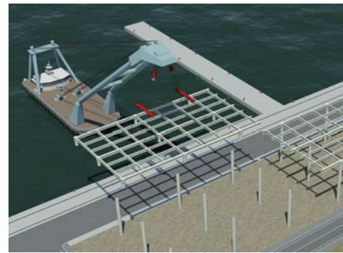
図2 大型起重機船による大ブロック架設
